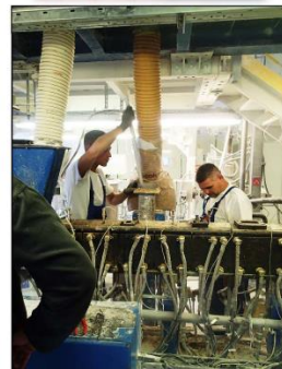
Industrial scale extruder (~500-1000kg/h)
